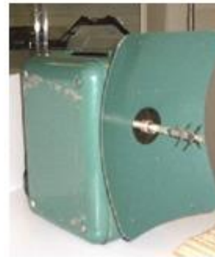
Telurómetro MRA-2 (1956), distanciómetro de ondas radio-eléctricas
