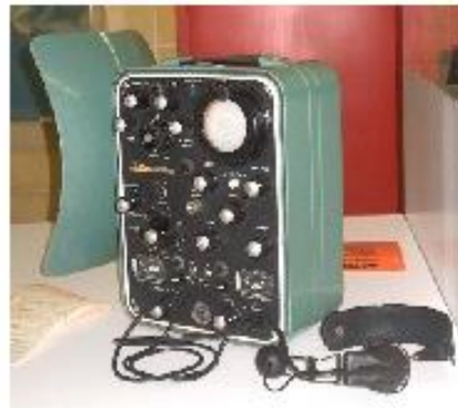
Telurómetro MRA-2 (1956), distanciómetro de ondas radio-eléctricas
